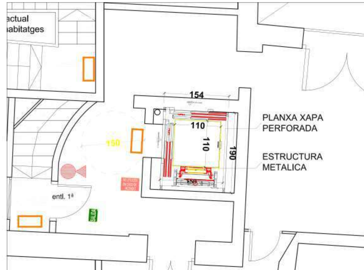
PATI 3 / ASCENSOR / PLANTA ENTRESOL ESC: 1/50
